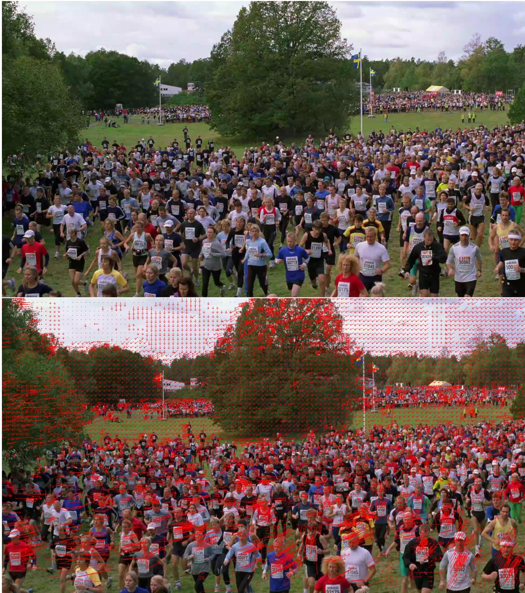
**Abbildung 2.6:** Interkodierung bei H.264/AVC am Beispiel zweier P-Frames. Die roten Pfeile im unteren Einzelbild sind die Bewegungsvektoren (MV), die auf die Stelle zeigen, an der sich der jeweilige Makroblock im Referenzframe (oberes Bild) befand.
