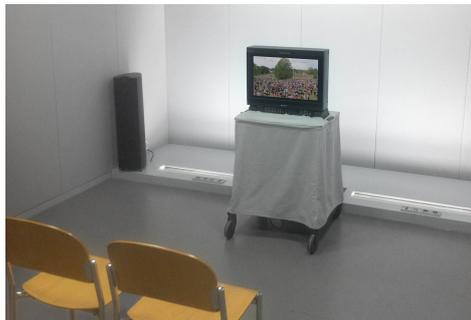
**Abbildung 1.1.:** Videolabor nach ITU-R Rec. BT.500
